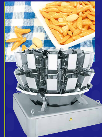
柿の種とピーナッツがつねに一定の割合になるようにはかるのは、イシダの「組み合わせ計量機」。他にも、スーパーの電子値札や包装機、POSレジなど、一見わかりにくい身近なところにイシダの製品が使われている。
