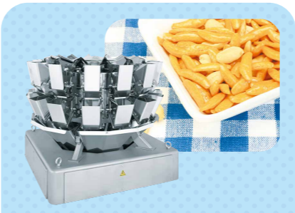
たとえば柿ピー、柿の種とピーナッツがつねに一定の割合になるようにはかるのはイシダの「組み合わせ計量機」だ。
