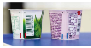
印刷面につけられた、2つの黒い点。これは、ラベルの貼り付け不良を見つけるための工夫だ。2つの点が平行でないものは、ラベルがゆがんでいるということ。自社製・カメラ付きの検査機器で不良要因を自動分析している。
